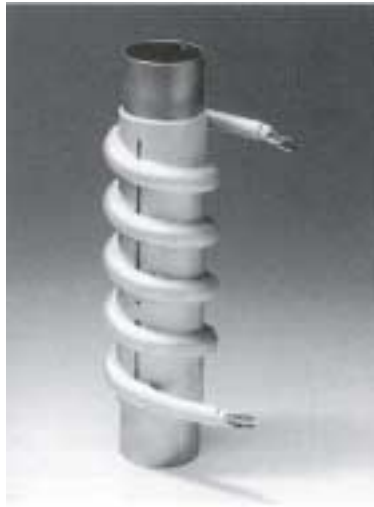
Bild 3: Pastenlötung unter Schutzgas an einem Durchlauf-erhitzer (Aluminium an vernickelten Stahl)
